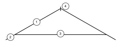
**CLOSED-COUPLE ROOF TRUSS**
