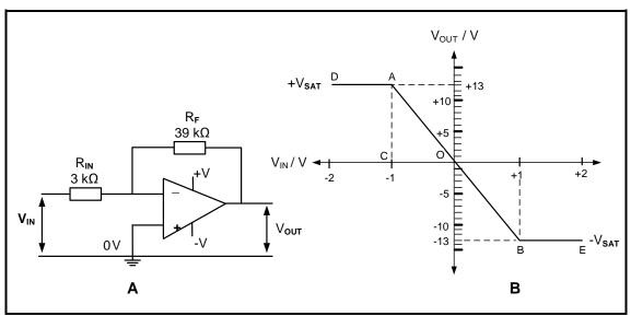
FIGURE 4.7: INVERTING OPERATIONAL AMPLIFIER
